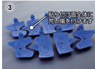
写真③ スライダー裏面の研磨 ※スライダー全てを同様に削ります
