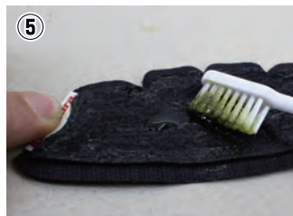
写真⑤ ボンドの塗布 ※付属のブラシでたっぷりとボンドをスライダーと交互に4回以上塗布します
