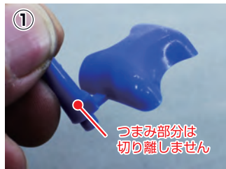
写真① パーツの準備 ※作業中に必要な分ですので、写真のつまみ部分は残しておきます
