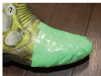
写真⑦ ベースの接着・圧着 ※ビニールラップと養生テープで、しっかりと接着部分を圧着します。
