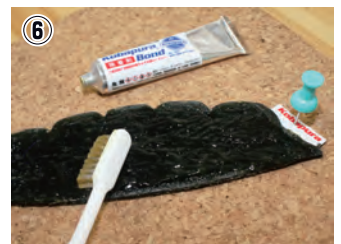
写真⑥ ベースへのボンド塗布 ※付属のブラシでたっぷりとボンドを4回以上塗布します
